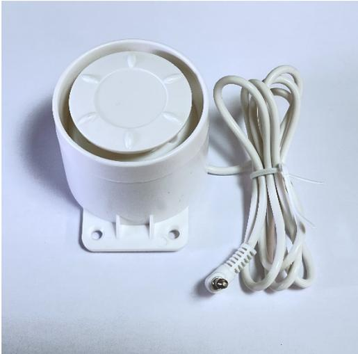
La sirena se conecta a la Central de Alarma mediante conector mini-Jack de 3,5mm como se aprecia en la imagen.
